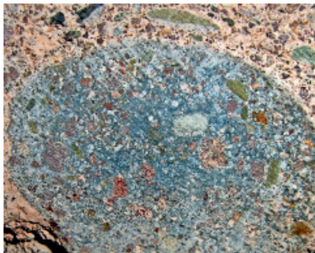
Abbildungen 1 und 2: Zementlinsen mit enthaltenen Gesteinskörnern (I.) und „nahezu reine“ Zementlinse mit erheblicher Größe.
