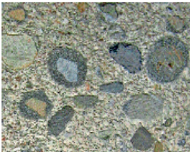
Abbildungen 1 und 2: Zementlinsen mit enthaltenen Gesteinskörnern (I.) und „nahezu reine“ Zementlinse mit erheblicher Größe.
