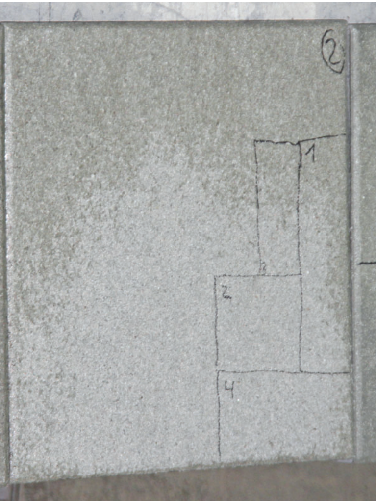
Abb. 10: Teilflächige Aufhellung, die mit einem Glanzverlust in Verbindung stand.
