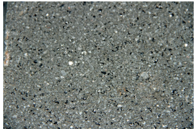
Abb. 15: Farbunterschied aufgrund eines lösenden Angriffes auf die Oberflächenvergütung der oberen Betonplatte
