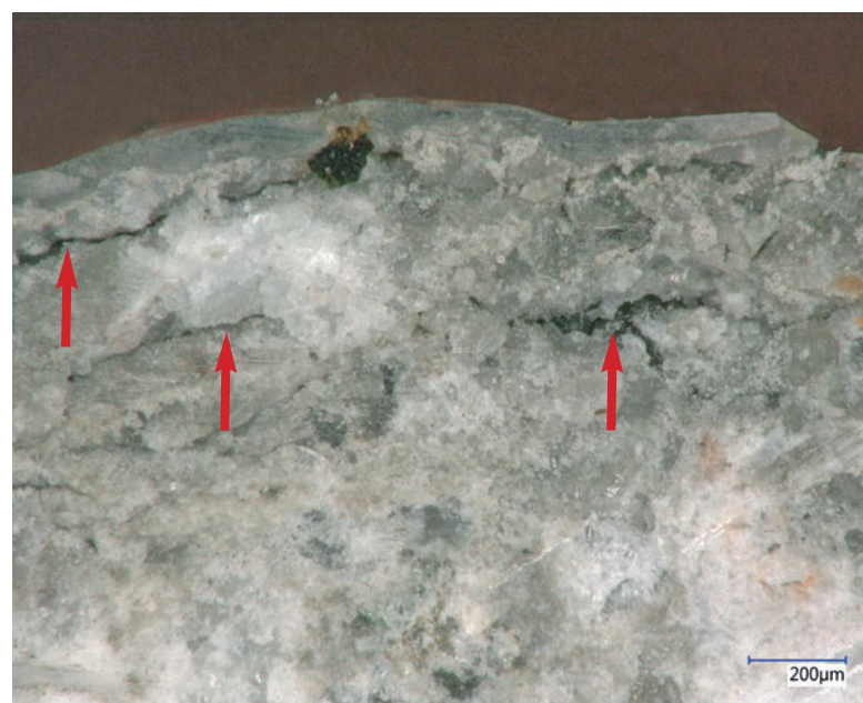
Abb. 12: Oberflächenparallel verlaufende Risse im oberflächennahen Beton
