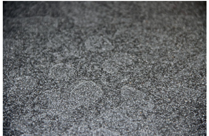
Abb. 13: Eintrübung einer Oberflächenvergütung durch die Bestrahlung mit UV-Licht
