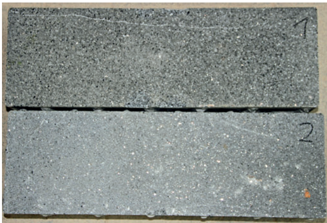
Abb. 15: Farbunterschied aufgrund eines lösenden Angriffes auf die Oberflächenvergütung der oberen Betonplatte
