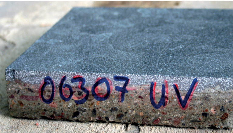
Abb. 13: Eintrübung einer Oberflächenvergütung durch die Bestrahlung mit UV-Licht
