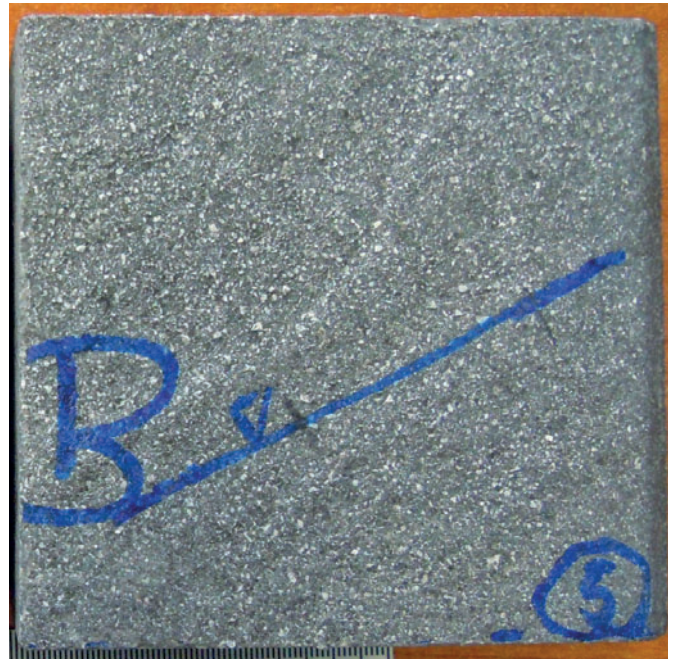
Abb. 3: Über die Betonplatte verteilt auftretende kleinflächige Aufhellungen
