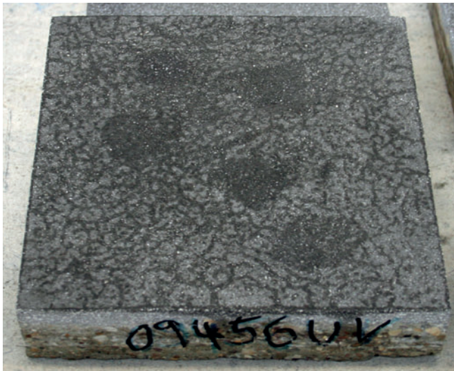
Abb. 14: Schumpfrissbildung in der Oberflächenvergütung durch die Bestrahlung mit UV-Licht
