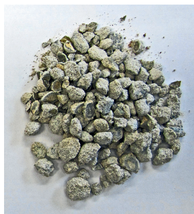
Abb. 2: Aus dem Bettungsmörtel separierte Zementlinsen
