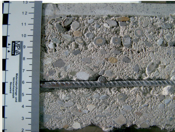
5 Entstehung von Trennschichten beim Einsatz von Bewehrung
