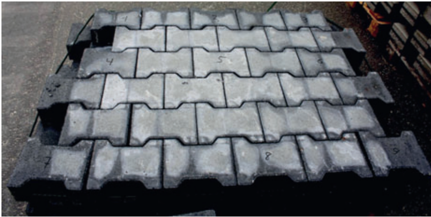
Bild 10: Ausgeblühte Pflastersteine bei Palettenlagerung
