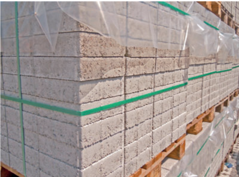
Bild 12: Pflastersteine bei sehr enger Palettenlagerung
