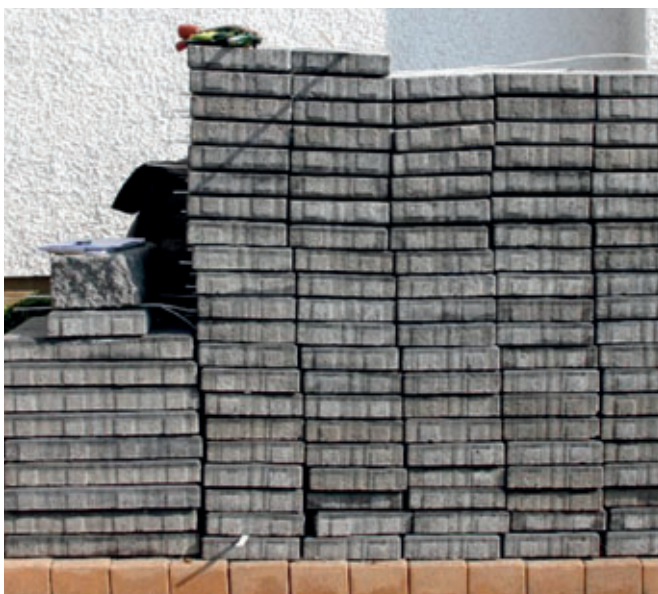
Bild 14: Folgen einer falschen Lagerung von Betonprodukten auf der Baustelle
